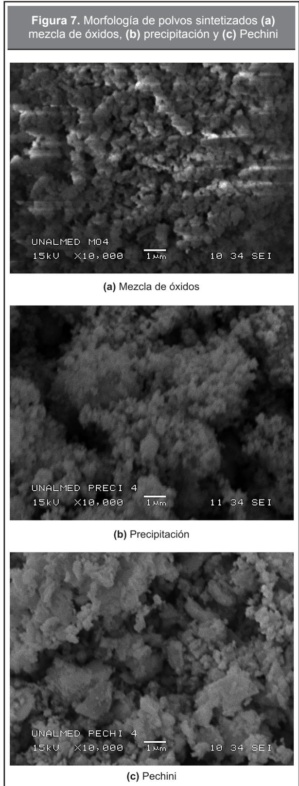
**Figura 8.** Morfología del material sinterizado (a) mezcla de óxidos (b) precipitación (c) Pechini
