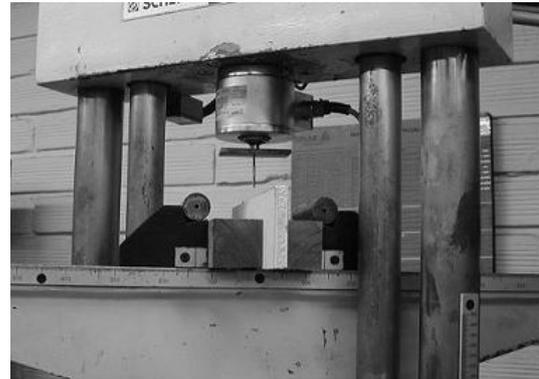
**Figura 7.** Especímen de placa comercial de *drywall*
