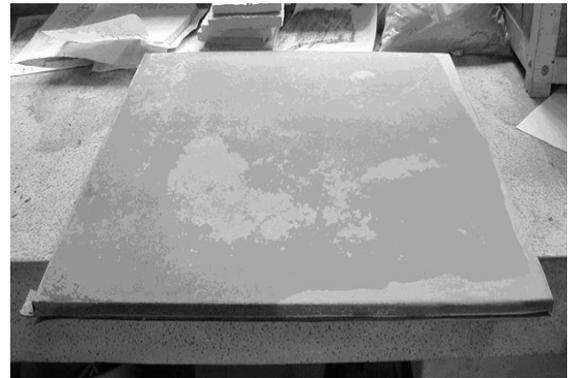
**Figura 3.** Paneles recién desmoldados
