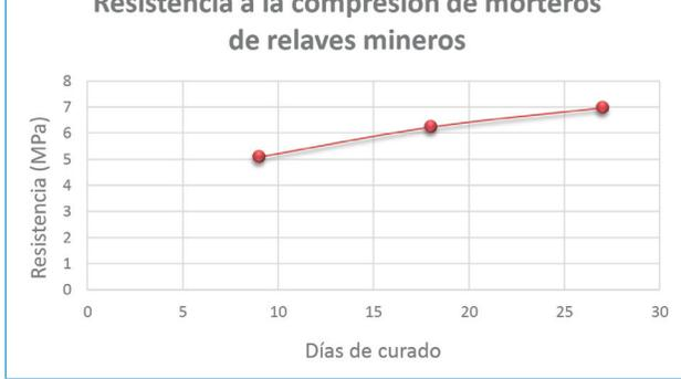
Como se observa en la Figura 5, la resistencia de los cubos de mortero aumentó al incrementar los días de curado, finalizando a los 28 días de curado en 1 MPa por encima de la resistencia para la cual se diseñó de 6 MPa, lo cual permite que efectivamente estos morteros puedan ser utilizados en revoque de acuerdo al diseño de mezcla realizado.
