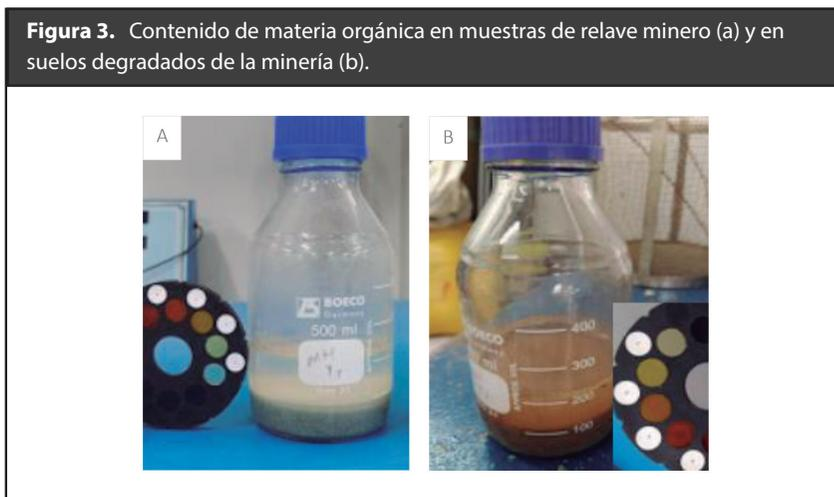
Como se observa en la Figura 3, posterior a 24 horas de asentamiento al realizarse la evaluación comparativa con la escala de color de Gartner, se determinó que la muestra evaluada no presenta contenido orgánico nocivo al ser utilizadas en la fabricación de materiales de construcción.
